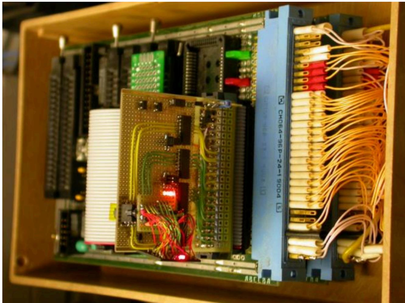
為了調式所有用於NAND通訊的定制命令，製作一個簡易的適配器電纜，用於將帶有NAND晶片的中間板插入自製的通用編程器。
