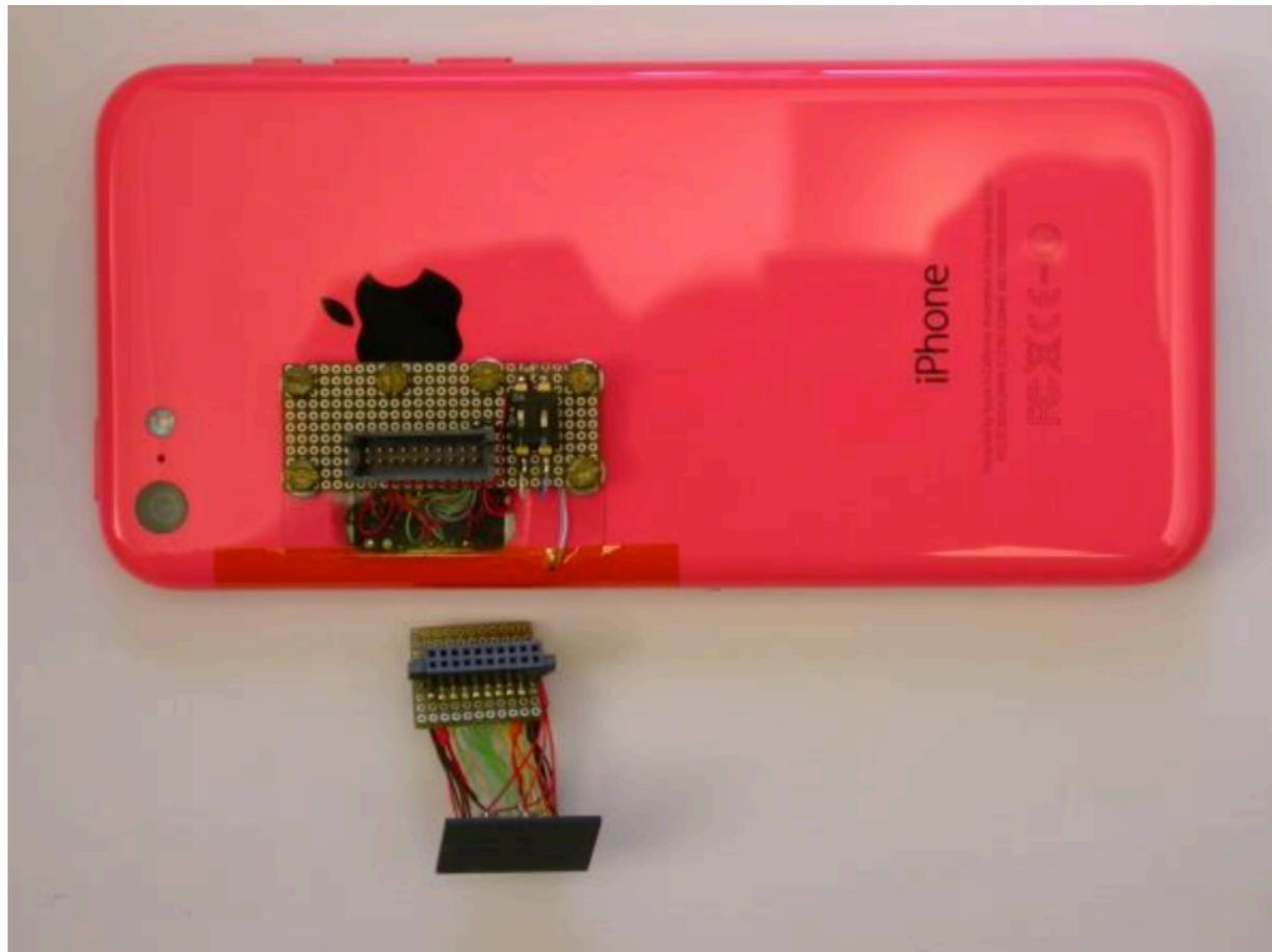
**NAND拆解後，為補助信號分析，連接到一個小型連接器。**
