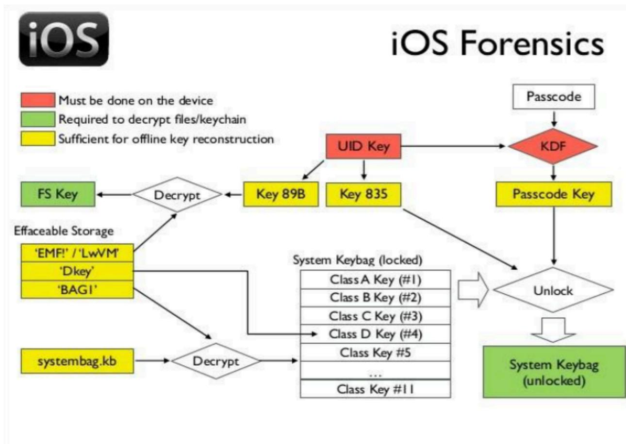
IOS的加密密鑰管理如圖所示，唯一的UID Key用於計算解鎖”System Keybag”的密碼密鑰。
