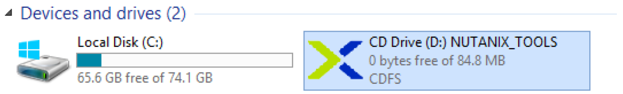
图 3.3.7 启动 NGT 安装 - 虚拟机操作系统中的光驱设备
